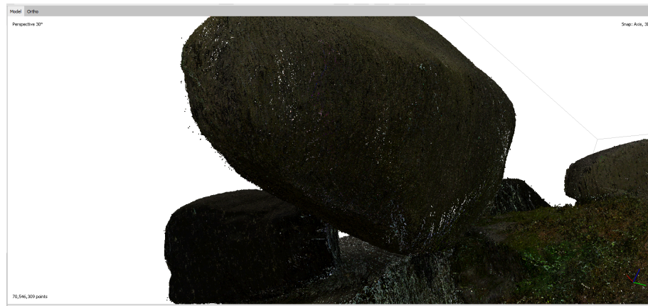
(Abb.5: deutlicher erkennbare “Ausreißer” nach Smoothing-Algorithmus)
