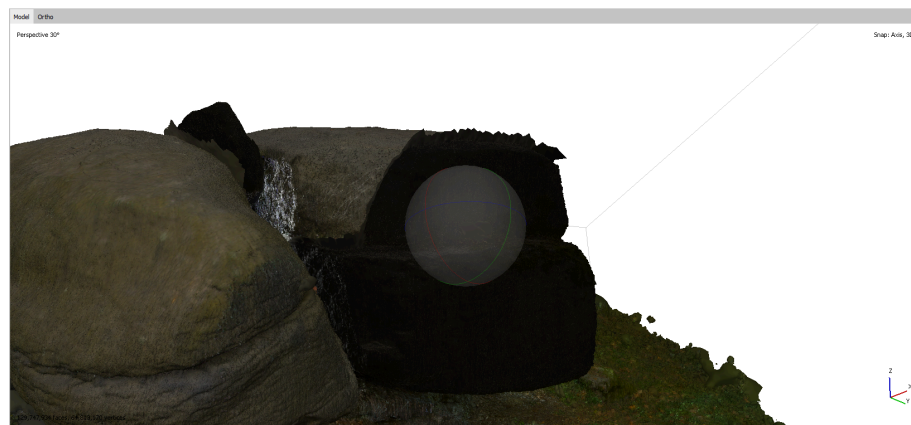
(Abb.6: Mesh mit falsch berechneten Normalenrichtungen)
